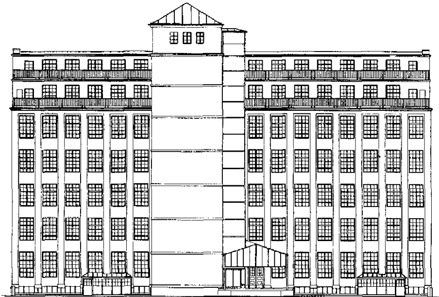
Abb. 2—5 / Siemenswerke, Blockwerk II / Abb. 2 und 3 (links): Aufriß der Süd- (oben) bzw. Nordseite (unten) / Abb. 4 und 5 (rechts): Grundriß des Kellergeschosses (oben) und des Erdgeschosses (unten) / Architekt: Hans Hertlein, Berlin Die Frontlänge beträgt 50 m, die Entfernung von Mitte Pfeiler zu Mitte Pfeiler 2,75 m
